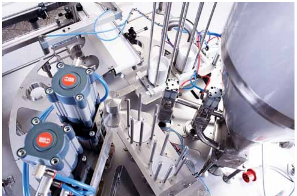
Рис. 5. Карусельний вузол подачі упаковки, фасування продукції та герметизації упаковки з ламістеру
