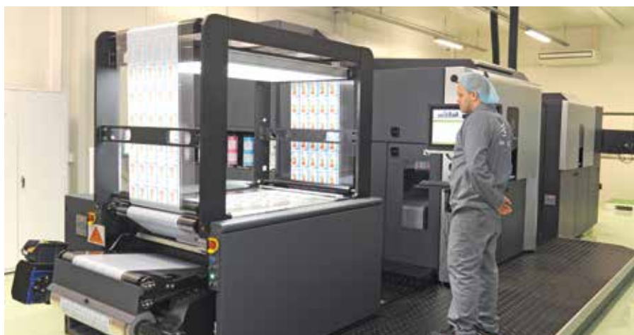
Цифровая печатная машина HP Indigo 20000 — новейшая технология печати на упаковочных материалах
