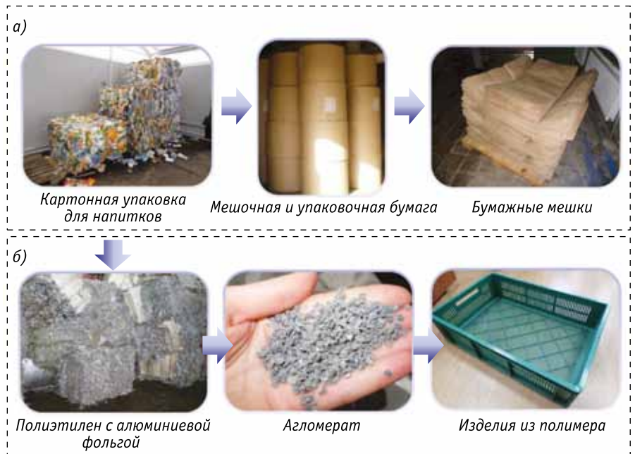
Рис. 3. Переработка отходов упаковки в ООО «АСС-Змиевская бумажная фабрика» (а) и в ООО «АСС-ХарьковПласт» (б)
