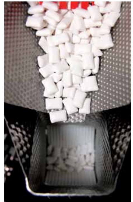
Рис. 3. Дозатор с поверхностью из банколана, который предотвращает повреждение жевательной резинки
