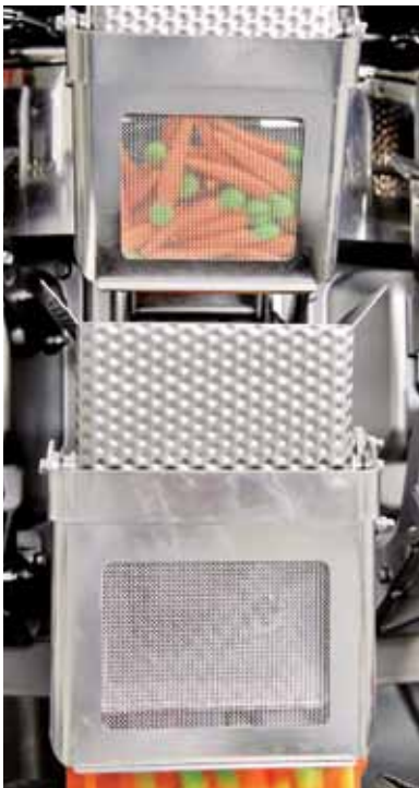
Рис. 2. Дозатор для липких желеобразных изделий с антиприлипающим покрытием контактных частей, включая металлическую сетку бункерных затворов
