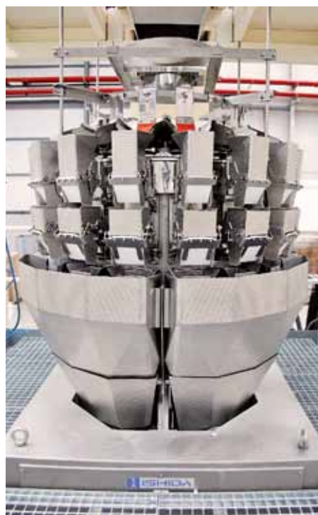
Рис. 1. 16-головочный весовой дозатор с двойной выдачей дозы продукции
