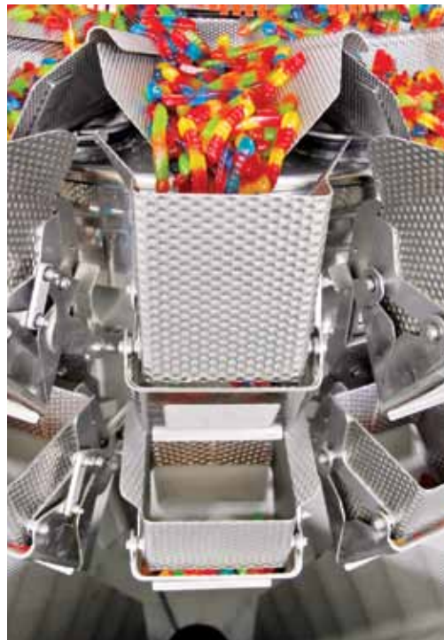
Рис. 2. Дозатор для липких желеобразных изделий с антиприлипающим покрытием контактных частей, включая металлическую сетку бункерных затворов
