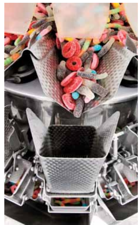
Рис. 1. 16-головочный весовой дозатор с двойной выдачей дозы продукции
